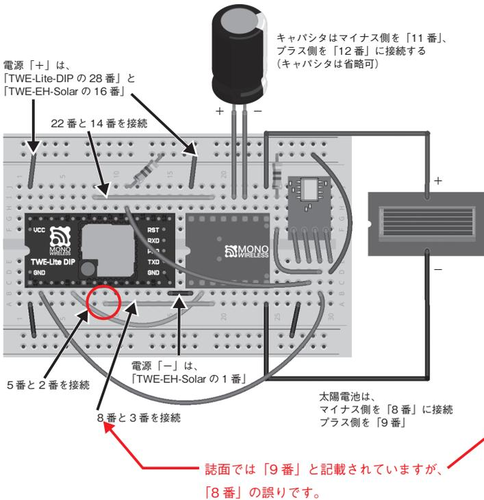
図 6-28 「TWE-EH Solar」と「TWE-Lite DIP」の組み合わせ
