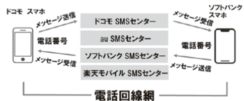
SMS/MMSのメッセージ送受信の仕組み
